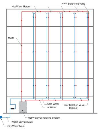
FIGURE B.2(A) VERTICAL DISTRIBUTION SYSTEM (SIMPLE)
